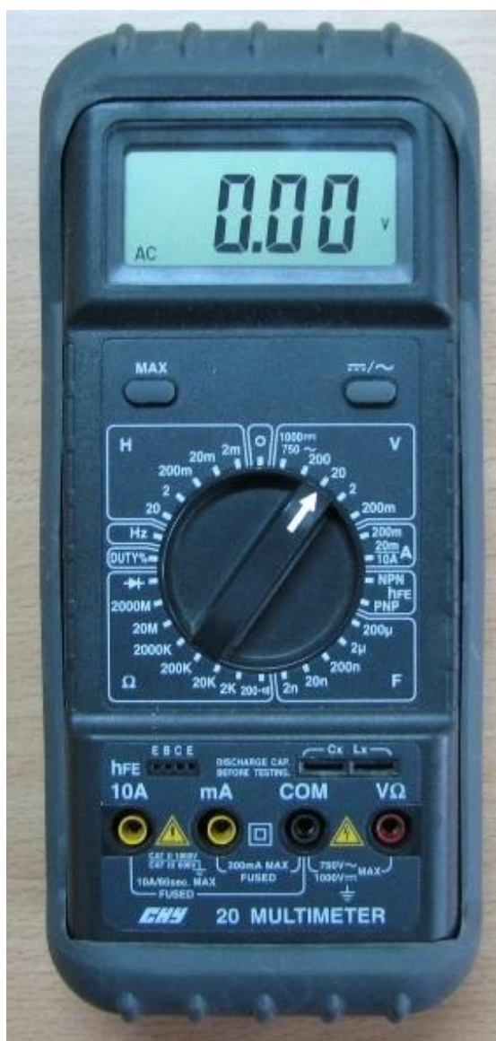
Rys. 1. Płyta czołowa multimetru CHY 20
