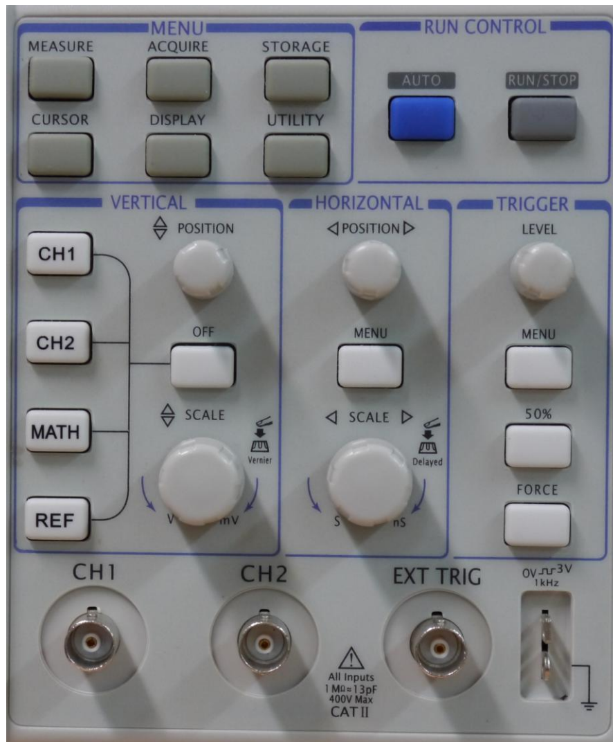
Rys. 2. Widok płyty czołowej oscyloskopu RIGOL DS 5062MA
